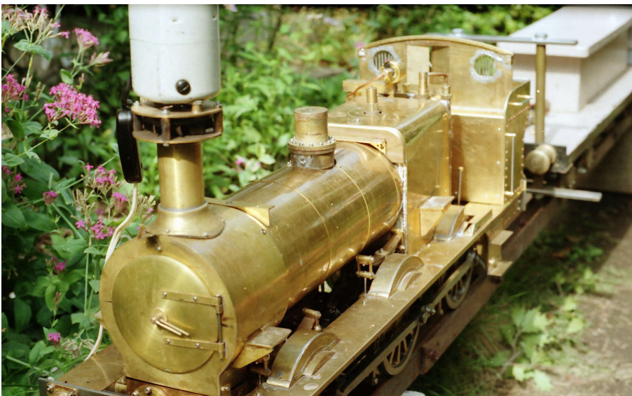
サイドタンクを付ける前、走行テスト。ミシン用モーターを利用したブローで、蒸気上げ。
